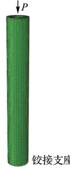
图8 管桩试件有限元模型示意图
