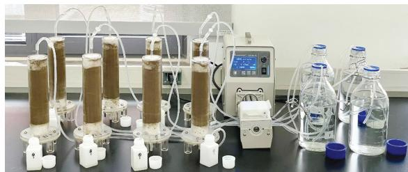
图 1 土柱淋洗装置图
