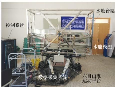
图 1 减摇水舱试验台架
